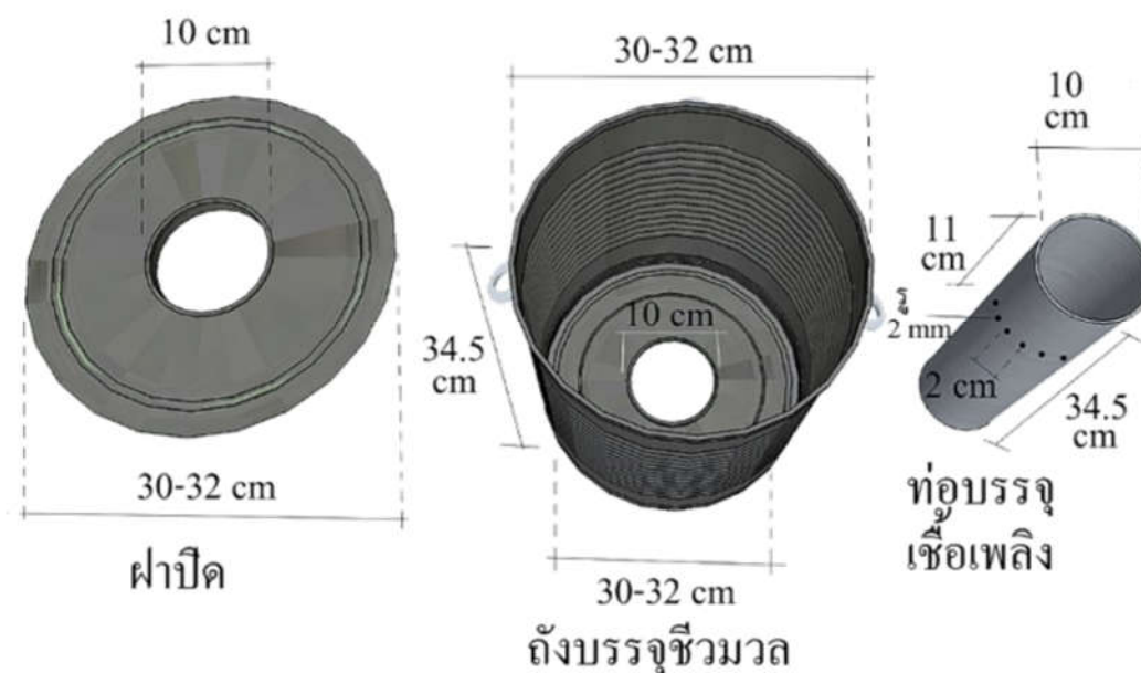
ภาพที่ 2 ส่วนประกอบของเตาผลิตแก๊สและไบโอชาร์
