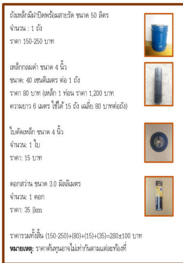
ภาพที่ 3 วัสดุอุปกรณ์ในการทำเตาผลิตแก๊สและไบโอชาร์
